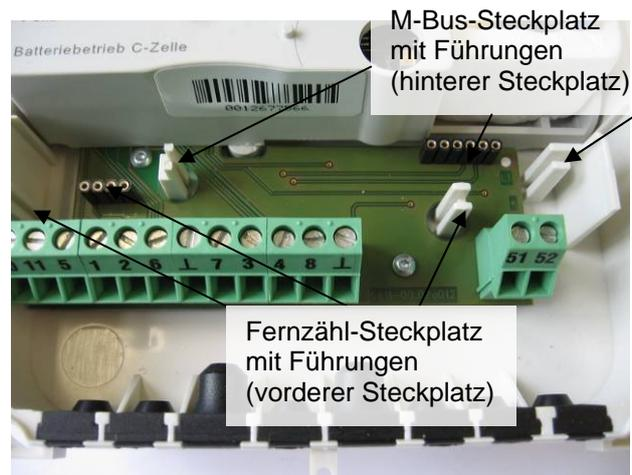
Bild 2: Steckplätze Rechenwerksgehäuse 2
