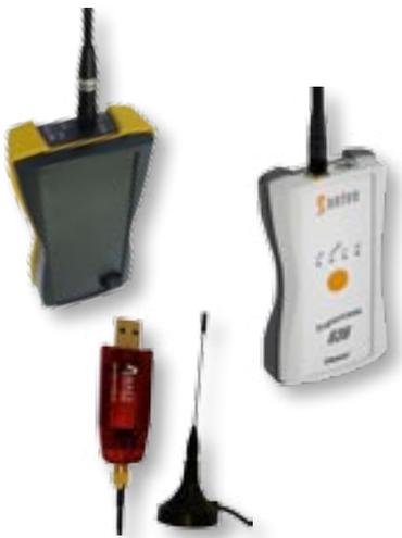
Der **MBWBLUE** ist ein mobiler Wireless M-Bus Modus T1, T2, C1 Empfänger / Sender (EN13757-4 / OMS) mit Bluetooth-Schnittstelle und Stromversorgung per Lithium-Ionen-Akku. Zusammen mit einem geeigneten Handheld-Computer (PDA oder Notebook mit Bluetooth-Schnittstelle) hat man ein leistungsfähiges mobiles Funkzählerauslesesystem.
