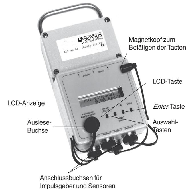
Der CDL DATA-Logger ist ein mobiler, robuster und gegen Feuchtigkeit geschützter Datenspeicher, der Messwerte unabhängig von äußerer Stromversorgung aufzeichnet.
