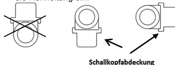
Abb. 6: Empfohlene Einbaulage bei Kältezählung
