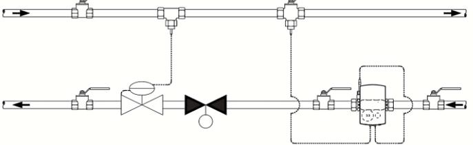
Abb. 4: Einbau für Kreislauf mit z. B. Drosselschaltung (Durchflusssensor in Fließrichtung vor Regelventil / Differenzdruckregler)
