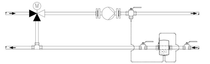
Abb. 3: Einbau für Kreislauf mit Beimischung; Platzierung der Temperaturfühler
