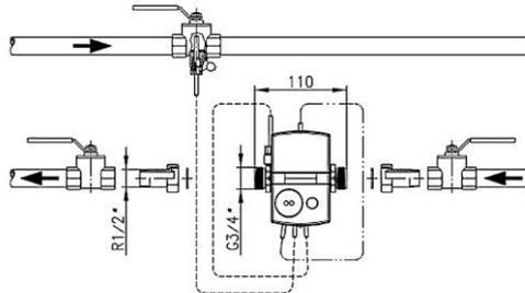
Abb. 2 Beispiel für Einbau mit Kugelhahn und Zähler mit 110 mm Armatur
