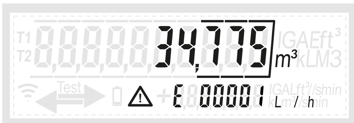
Abb. 19: Die «Luft im Wasser» Fehlermeldung erscheint während der Installation des Zählers
