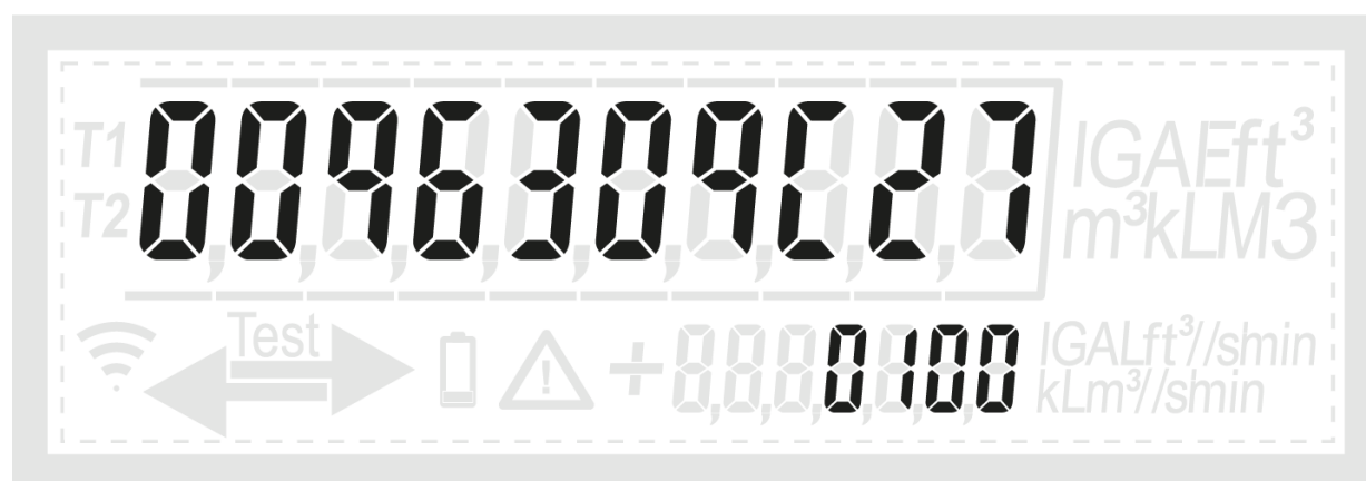
Abb. 22: Zweite Sequenz: Beispiel für Firmware-LCD-Prüfsumme (oberes Feld) und Version (unten)
