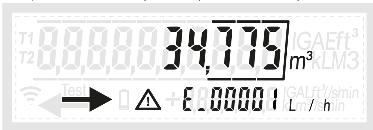
Abb. 20: Warnsymbol und Fehlercode wird in der Anzeigereihenfolge dargestellt
