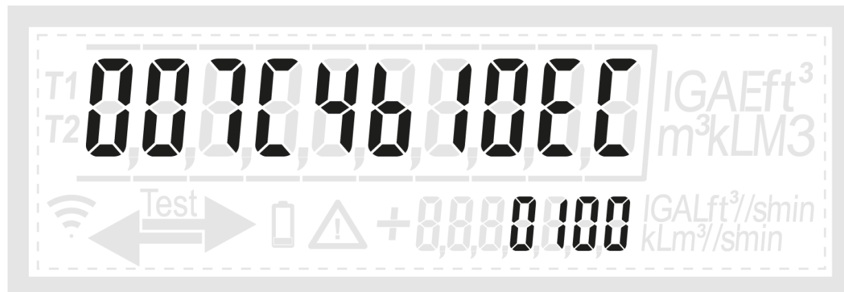
Abb. 21: Erste Sequenz: Beispiel für metrologische Firmware-Prüfsumme (oben) und Version (unten)
